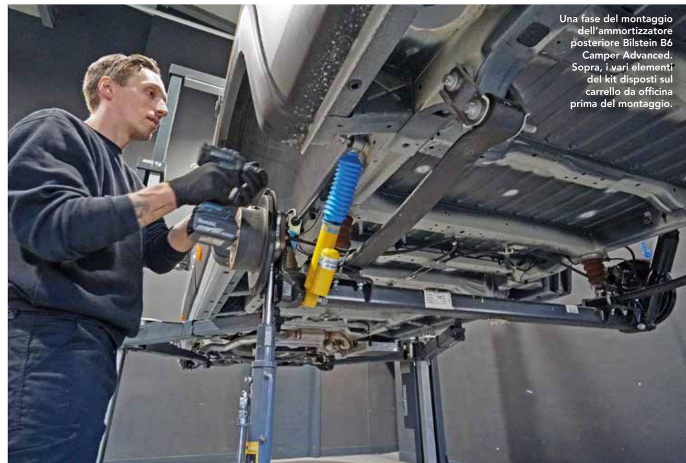
Una fase del montaggio dell'ammortizzatore posteriore Bilstein B6 Camper Advanced. Sopra, i vari elementi del kit disposti sul carrello da officina prima del montaggio.
