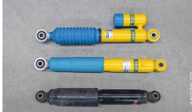
**IN QUESTA FOTO DA SOTTO A SOPRA:** l'ammortizzatore posteriore originale, il Bilstein B6 Camper e il B6 Camper Advanced.
